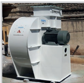
هواکش 1500RPM 45KW
