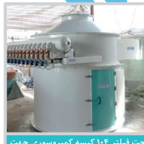
جت فیلتر ۱۰۴ کیسه کمپرسوری جهت غبارگیری واسپیراسیون
