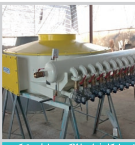
تبدیل کله فیلتر ۷۸ کیسه بلوئری ترکیه به سیستم کمپرسوری
