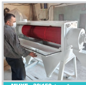
پوستگیر مدل MHXF - 30/150 ظرفیت ۱۳ تن در ساعت
