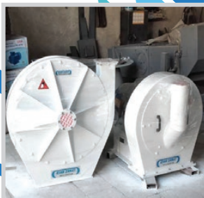
آسیاب چکشی به همراه پنوماتیک ۱۱ کیوات
