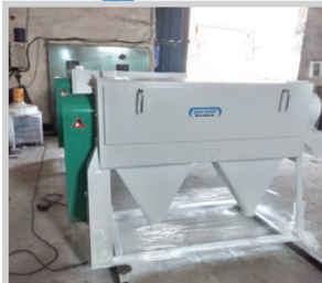
پوستگیر مدل MHXF - 30/150 ظرفیت ۱۳ تن در ساعت
