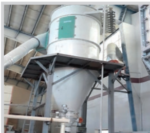
جت فیلتر ۷۸ کیسه کمپرسوری جهت غبارگیری و اسپیراسیون
