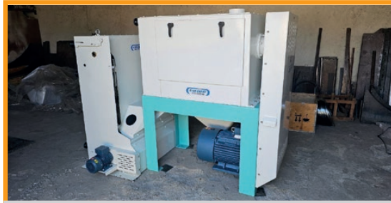
پوستگیر سایشی مدل MHXS - 45/80 ظرفیت ۱۰ تن الی ۲۵ تن در ساعت
