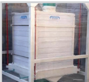
الک کنترل مدل MBG - 115 / 115 ظرفیت ۱۰ تن در ساعت با مش ۱۰۰۰ میکرون
