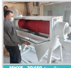
پوستگیر مدل MHXF - 30/150 ظرفیت ۱۳ تن در ساعت
