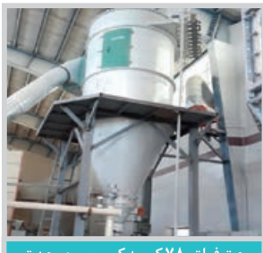
جت فیلتر ۷۸ کیسه کمپرسوری جهت غبارگیری و اسپیراسیون
