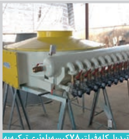
تبدیل کله فیلتر ۷۸ کیسه بلوئری ترکیبه سیستم کمپرسوری
