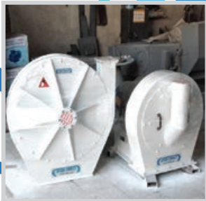
آسیاب چکشی بهمراه پنوماتیک ۱۱ کیوات
