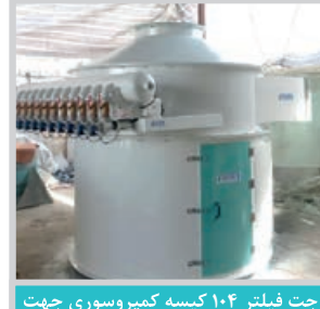
جت فیلتر ۱۰۴ کیسه کمپرسوری جهت غبارگیری واسپیراسیون
