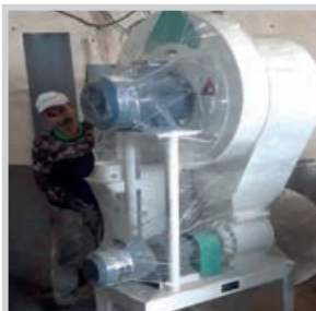
جدانکننده سنگ از فضولات بوچاری (شنگیر کوزل)
